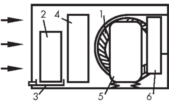
Der Lüfter (1) saugt die feuchte Luft ein und leitet sie durch den Verdampfer. Hier wird die Luft gekühlt und die darin vorhandene Feuchtigkeit kondensiert zu Wasser, das in die Kondensatwanne tropft und von hier durch den Schlauch abläuft.
